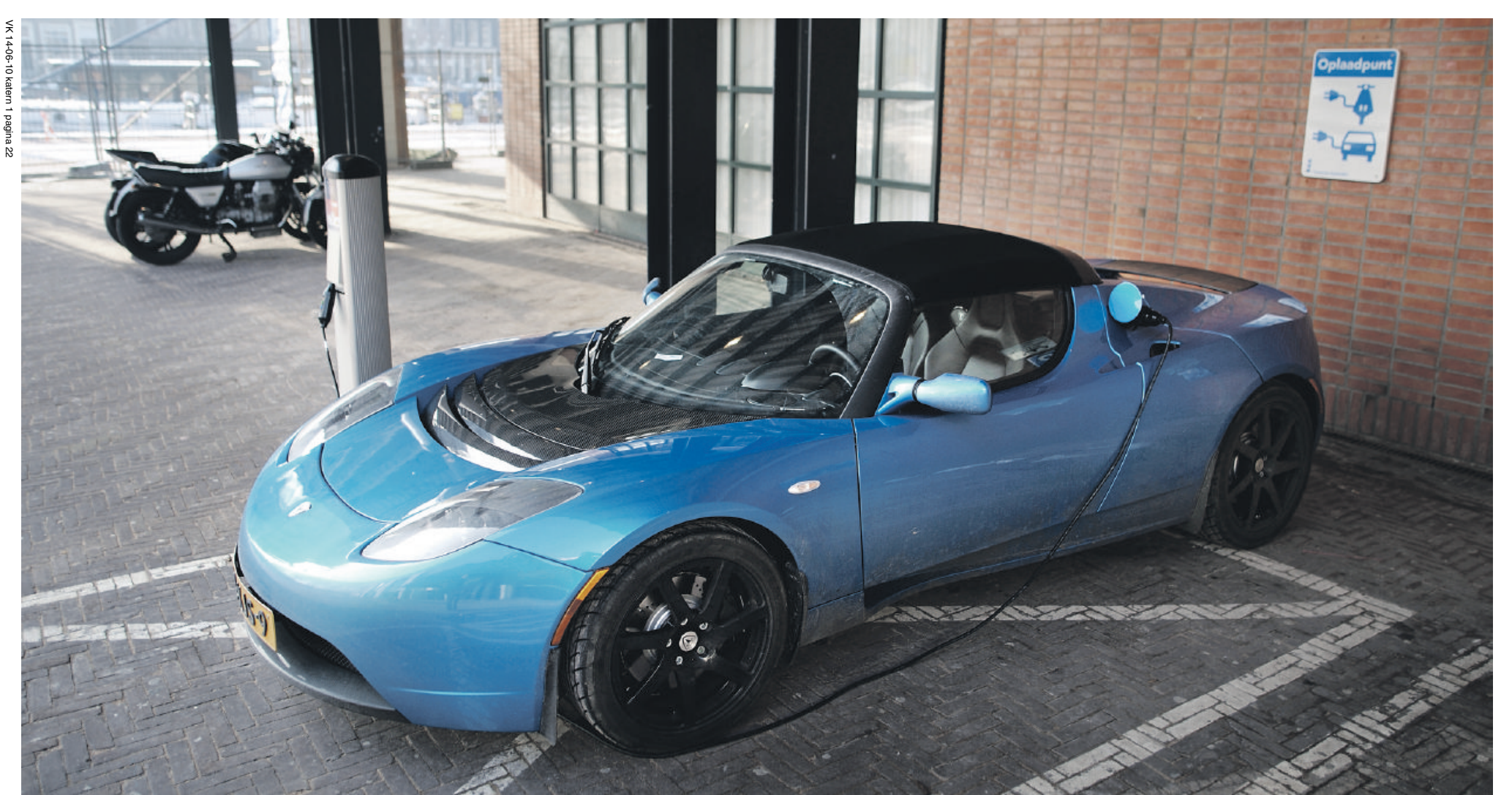
Een elektrische auto wordt opgeladen bij het stadhuis van Amsterdam. Bij een 'ouderwetse' lader zoals hier duurt dat uren, maar een Nederlands bedrijf ontwikkelde een lader die de klus in dertig minuten klaart. 'Het denken over tanken gaat op de schop.'
